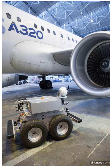
Figure 1. Air-Cobot en train d'inspecter un A320
