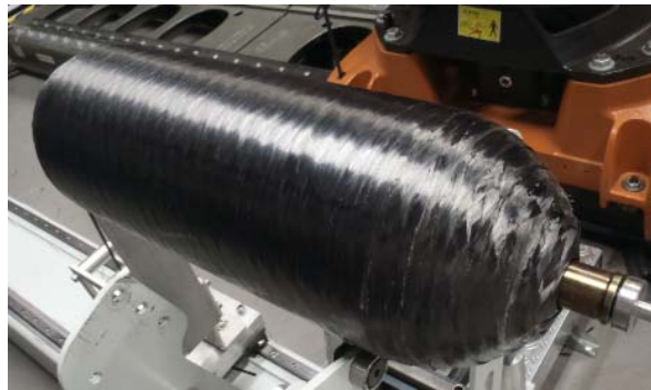
Figure 1. Réservoir composite thermoplastique conçu, fabriqué et testé en éclatement à plus de 900bar par le CETIM
