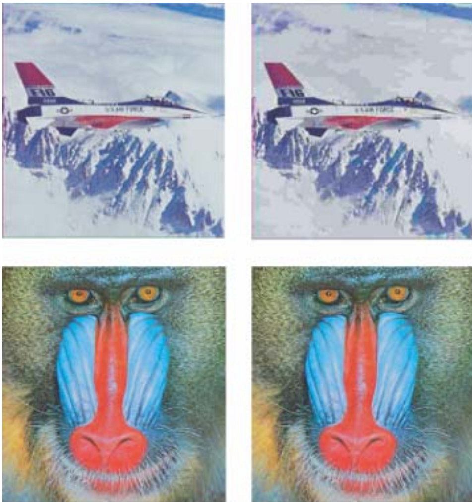
Figure 12. Exemples de couple d'images référence, dégradée. En haut image avion MOS = 1.38, PSNR = 26.14 dB, MOSp = 1.17. En bas image mandrill MOS = 4.51, PSNR = 24.09 dB, MOSp = 4.16.
