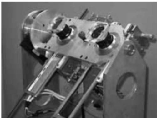
Figure 8. Photographie du capteur de vision omnidirectionnelle.
