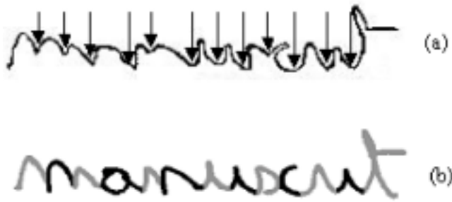
Figure 2. Points de segmentation potentiels sur le contour supérieur de l'image (a) et les images des graphèmes résultant (b).
