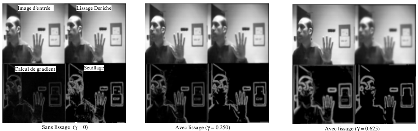
Figure 17. Segmentation d'images avec une séquence de 4 algorithmes : affichage en temps réel des résultats intermédiaires (7 configurations au total).
