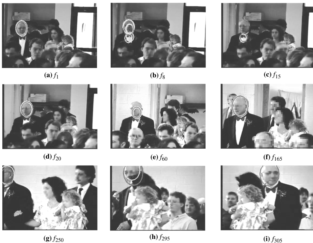
Figure 8. Suivi de tête 2 avec N_s = 500 , (\sigma_r, \sigma_s) = (5, 0.01) . Première ligne : suiveur de forme M1. Seconde et troisième lignes : suiveur de forme M2. En rouge (sombre), configuration moyenne. En jaune (clair), particules les plus vraisemblables.
