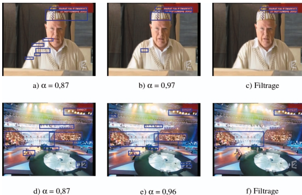
Figure 12. Optimisation sur la classe 3 : les résultats (a) et (d) sont obtenus avec le paramétrage initial de \alpha ; les résultats (b) et (e) sont produits pour un paramétrage différent ; les images (c) et (f) montrent les résultats du filtrage des fausses alarmes.
