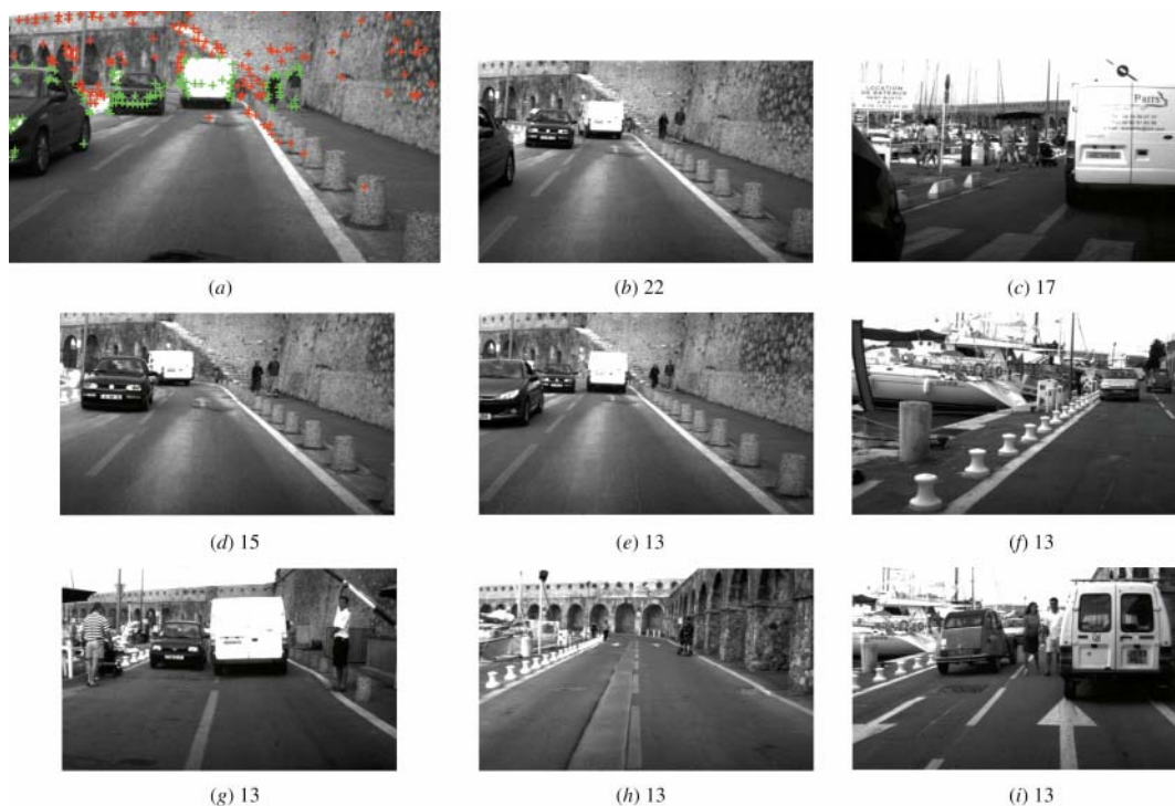
Figure 5. Localisation qualitative par recherche d'images. (a) : image requête. Les points de Harris sont tracés. Les points verts correspondent à des objets mobiles de la scène, et ne sont pas utilisés lors de la localisation. Images (b) à (i) : plus proches vues trouvées dans la base d'images. Le plus faible nombre de points de l'image requête utilisé, ainsi que leurs saillances plus faibles, expliquent les scores très proches obtenus.
