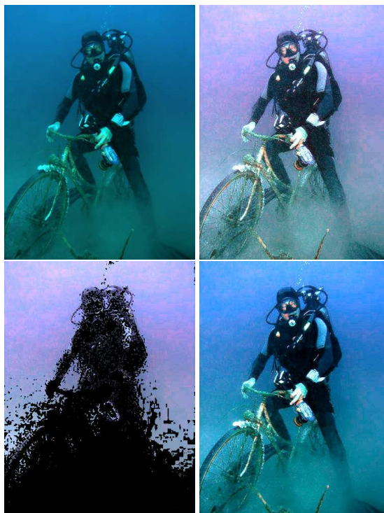
Figure 10. De gauche à droite : image source, correction automatique, extraction des pixels violets, ajustement de la correction
