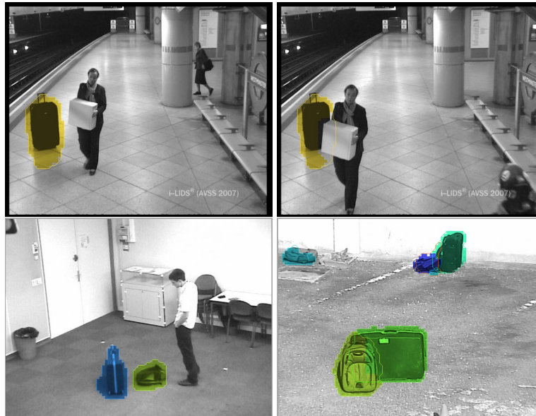
Figure 2. Les étiquettes objet sont maintenues jusqu'à réapparition du fond. Cette approche permet de maintenir une étiquette unique pour les blocs de la valise même après son occultation
