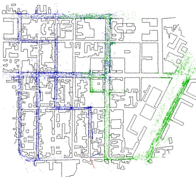
Figure 3. Concaténation de deux bases de données différentes (bleue et verte) dans le quartier de Versailles. Les point 3D redondants dans les deux bases sont détectés et fusionnés. Un ajustement de faisceaux global peut être par la suite réalisé afin d'améliorer la précision de la base résultante aux zones de recouvrement
