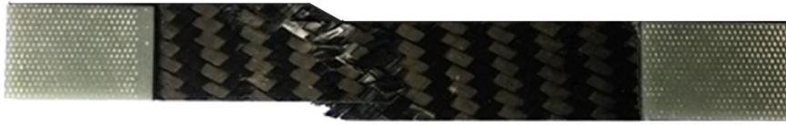
Figure 8. Illustration d'une rupture par cisaillement plan
