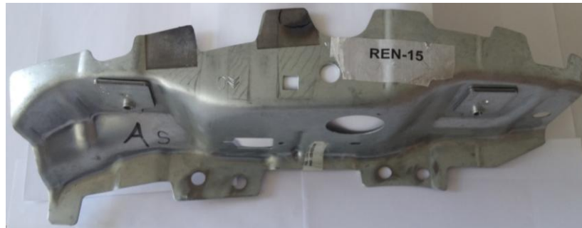
Figure 12. Photo du support en acier avec les 2 zones structurées, (sombres)
