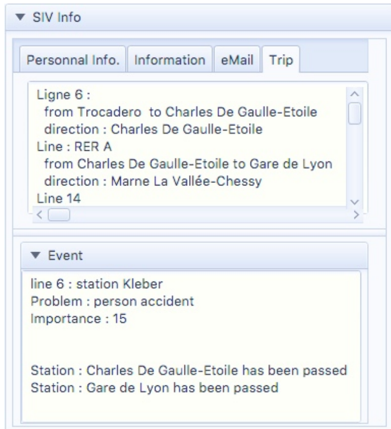
Figure 2. Une interface SIV alertant d'un événement imprévu dans le déplacement d'un usager
