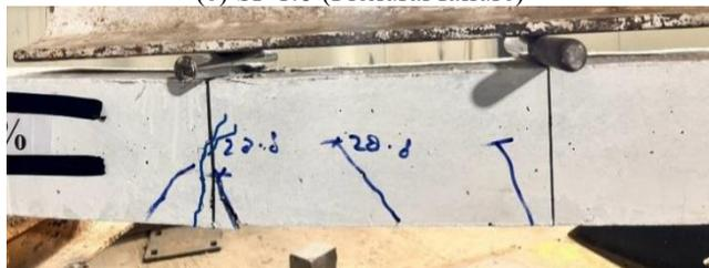
(d) SF 1.5 (Flexural failure)
