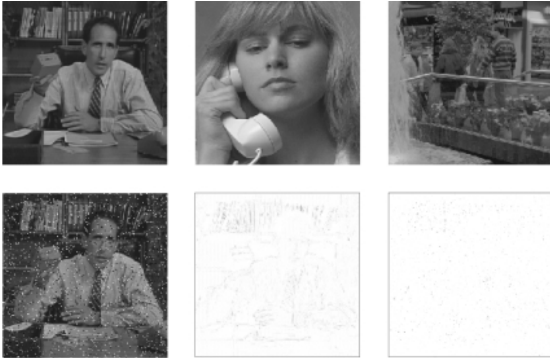
Figure 1. 5 ème trame de Salesman (a), Susie (b), People (c) (d) Salesman, la trame bruitée (bruit impulsionnel avec p = 0.1 ) (e) l'erreur estimée (EE) d'un filtre médian (filtre LUM avec k = 14 ) (f) EE d'un filtre LUM à réduction linéaire nk = 3
