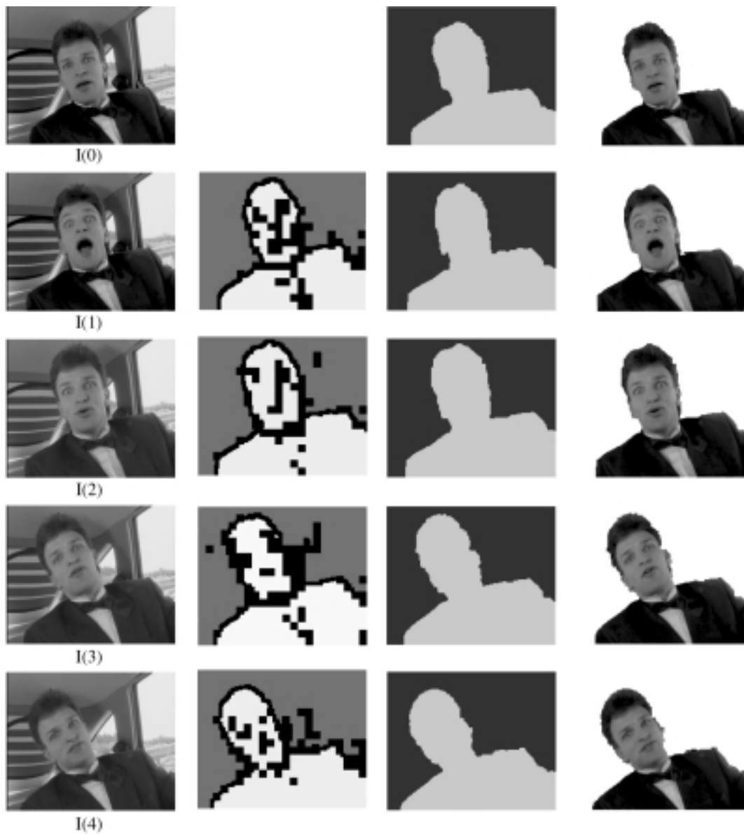
Figure 17. Suivi d'un objet non rigide dans la séquence fortement sous-échantillonnée CarphoneBis (La première colonne représente les images successives de la séquence, la seconde fournit le résultat de la projection de partition, la troisième présente la partition en objets obtenue, la dernière donne l'objet vidéo segmenté)
