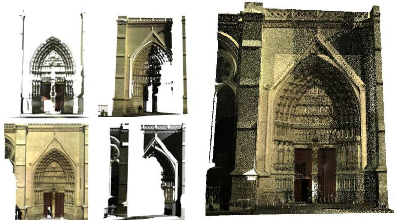
*Figure 3. Quatre nuages de points bruts obtenus à partir des différentes positions du scanner à laser (à gauche) et le nuage de points issu de leurs recalage (à droite)*
