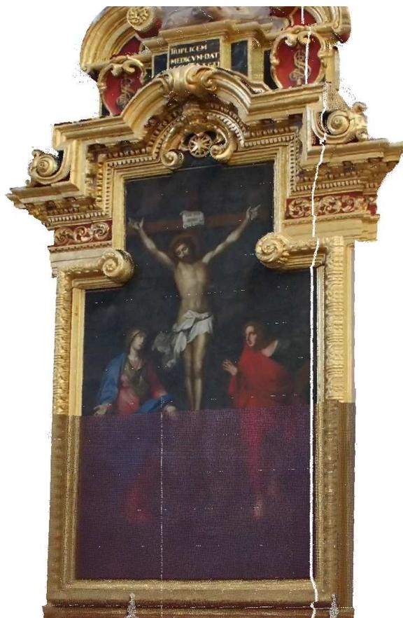
*Figure 16. Nuage de points de la Chapelle Saint Sebastien. Les points de la partie basse ont les couleurs prélevées par le scanner, ceux de la partie haute ont été colorisés via notre approche*
