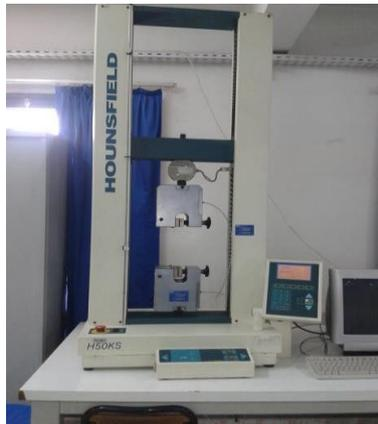
Figure 7. Appareil Hounsfield pour la réalisation d'essai de traction sur bandes textiles
